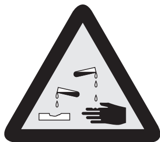
Gefährdung durch ätzende Medien! Schutzausrüstung erforderlich!
