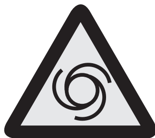
Gefährdung durch rotierende Teile! Gegen Inbetriebnahme sichern!
